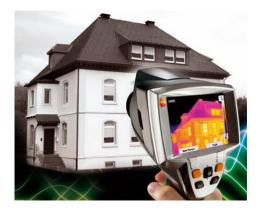
Eine Thermografieaufnahme stellt immer nur ein Bild der Oberflächentemperatur dar, es ist keine Röntgenaufnahme mit der man durch etwas hindurchschauen kann.
