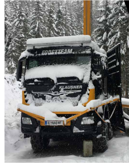
Mobile Seilbahn zur Holzbringung im Hochwald
